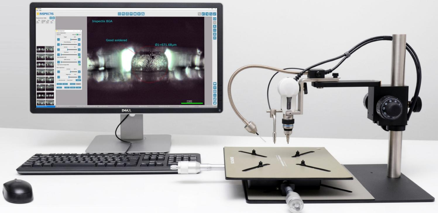
Превосходное качество изображения для быстрой инспекции, измерения и документирования скрытых паяных соединений BGA,  $\mu$ BGA, компонентов FlipChip, CSP, CGA и SMD.
