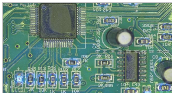
Плата с защитным покрытием, x7 зум, 12.9х увел. С УФ подсветкой
