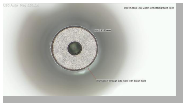
Механизм, x30 зум +5 макро, 101х увел. Кольцевая подсветка + фоновая подсветка
