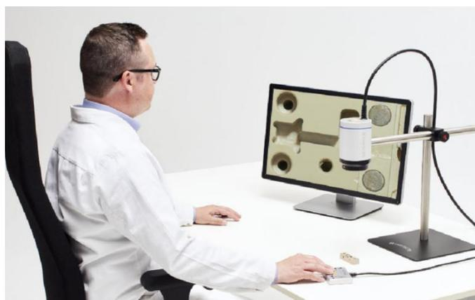
Благодаря быстрой оптике и большому датчику изображения F35 обеспечивает превосходное изображение объекта контроля, особенно паяных соединений на электронных печатных платах и металлических деталях, с минимальными бликами и отражениями.
