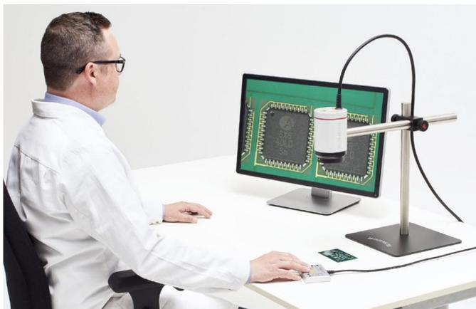
U30s, пример комплекта с камерой 4K на базовом штативе
