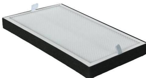
Вставьте фильтр внутрь корпуса угольного фильтра используя петельки. Фильтр располагается петельками вверх. HEPA фильтр не подлежит очистке после его полного засорения. Но вы можете продлить его срок службы, регулярно очищая его от крупной пыли.
