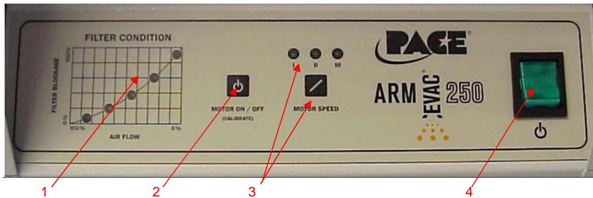
Дымоуловитель Arm-Evac 250 имеет индикатор состояния фильтров (1), который непрерывно показывает, насколько засорен фильтр. Чем больше засорен фильтр, тем выше на кривой индикатора загорается светодиод.
