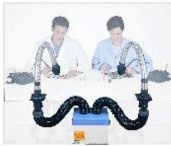
2 x 45мм гибкий дымоприемник
