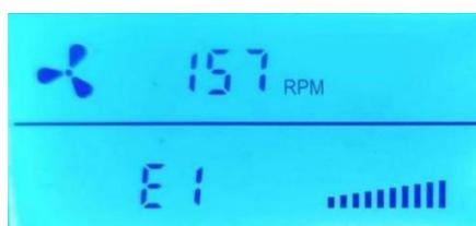
При обнаружении сигнала тревоги о блокировке фильтра, который сохраняется в течение 12 часов, машина автоматически остановится, и все данные на экране будут отображаться как "0". В это время линия вывода сигнала порта "Shutdown/Fault Alarm" выдает напряжение 12 В постоянного тока, и в сочетании с линией "Common Terminal" может быть получен выходной сигнал напряжения 12 В постоянного тока.
