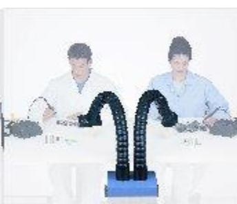
2 x 75мм гибкий дымоприемник
