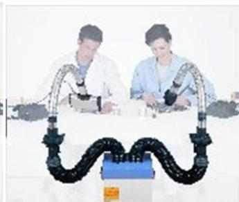
2 x 50мм гибкий дымоприемник
