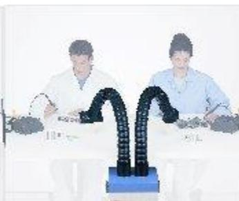
2 x 75мм гибкий дымоприемник
