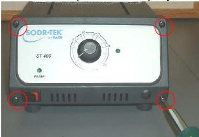
3. Вывинтите винты из боковин системы (по одному винту с каждой стороны).
