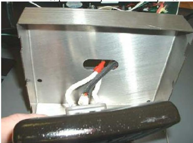
10. Возьмите новый нагреватель и вставьте его провода в отверстие в держателе, как показано на рисунке. Затем установите фиксатор нагревателя.
