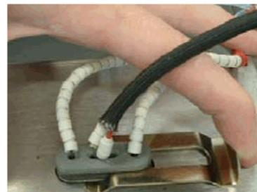
11. Затяните 4 винта с шестигранной головкой, закрепляющих держатель нагревателя.
