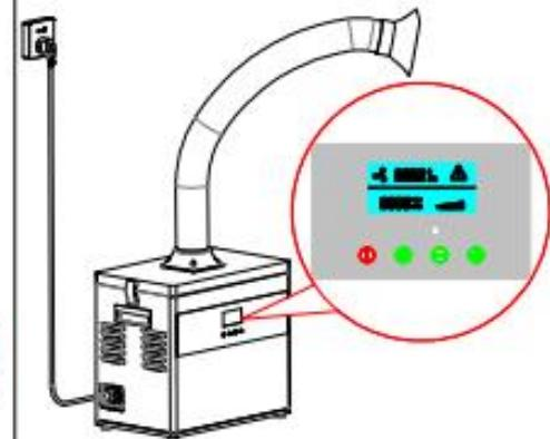
Нажмите на красную кнопку, чтобы включить вытяжку. Нажмите на + или -, чтобы настроить воздушный поток.
