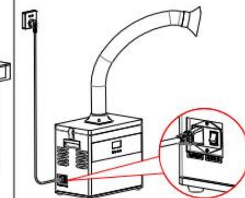
Включите выключатель питания на разъеме кабеля питания. На панели управления загорится красная кнопка и начнет мигать.
