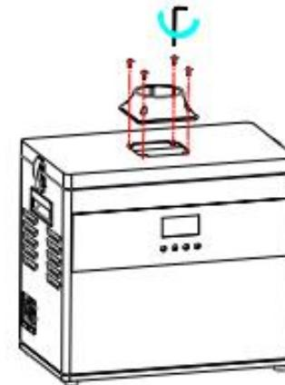
Прикрутите адаптер для дымоприёмника к верхней крышке блока при помощи только что выкрученных винтов.
