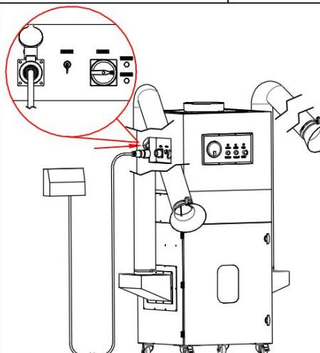
Когда машина подключена к питанию, и главный выключатель питания включен, горит зеленый светодиод на передней панели. Красный цвет означает неверное подключение питания.
