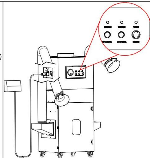
Поверните переключатель режима работы на Local. Вытяжка начнет работать. Для удаленного запуска машины установите переключатель в Remote и подайте 24 В на сигнальный кабель.
