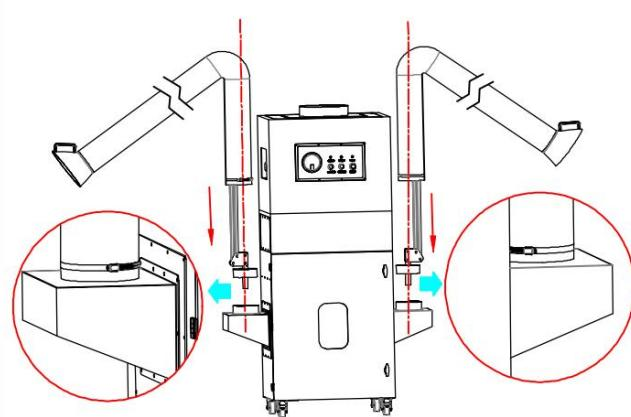
После распаковки дымоуловителя установите два комплекта дымоприёмников как показано. Используйте хомуты, чтобы уплотнить места соединения воздуховода и входного патрубка.
