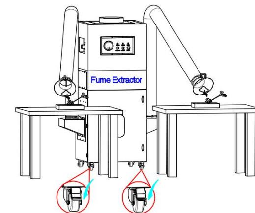
После распаковки дымоуловителя установите два комплекта дымоприёмников как показано. Используйте хомуты, чтобы уплотнить места соединения воздуховода и входного патрубка.
