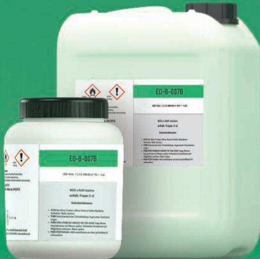
Как и все многофункциональные флюсы EO-B-007B может быть использован и для пайки волной (распылением), и для селективной пайки, ручной и погружением в припой. Версия В представляет собой стандартную версию с 3% твердых включений. Версия В также поставляется в дозированной бутылке или карандаше-диспенсере, что идеально для ручной пайки и ремонта.
