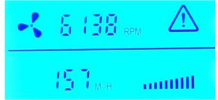
2.2. При обнаружении неисправности вентилятора на дисплее отобразится код тревоги E1 или E2. E1 - сигнал о недостаточной скорости вращения вентилятора, а E2 - сигнал о перегрузке вентилятора по току.
