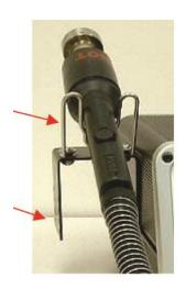
3. Соберите держатель инструмента и прикрепите его к боковой стенке корпуса блока управления.
