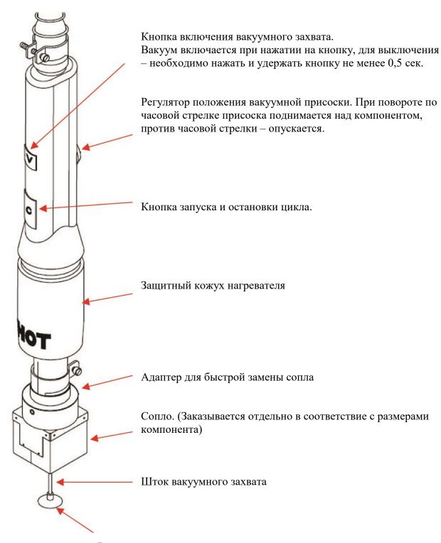
Вакуумная присоска для захвата и подъема компонента при демонтаже
