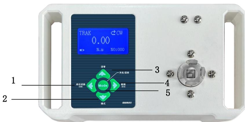
1. Переключатель единиц измерения (клавиша возврата): Возвращает к основному интерфейсу и сохраняет заданное значение параметра при настройке параметров; в основном интерфейсе это клавиша переключения единиц измерения.
