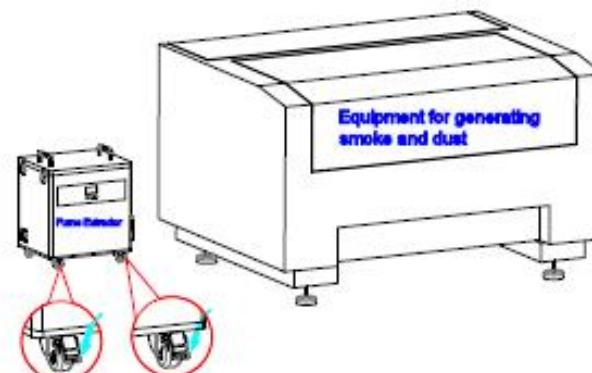
После распаковки дымоуловителя установите его рядом с вашим оборудованием и зафиксируйте стопорами на колесиках.
