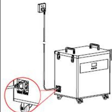
Включите выключатель питания на разъеме кабеля питания. На панели управления загорится красная кнопка и начнет мигать.
