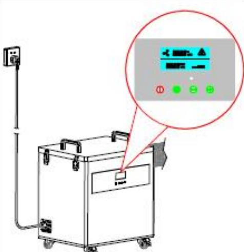
Нажмите на красную кнопку, чтобы включить вытяжку. Нажмите на + или -, чтобы настроить воздушный поток.
