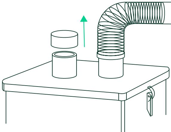
К входным патрубкам дымоуловителя можно подсоединить непосредственно дымоприемник или гибкие воздуховоды если дымоприемник установлен на удалении от блока дымоуловителя. Для подключения и фиксации дымоприемника или воздуховода используйте соответствующий адаптер и хомуты.
